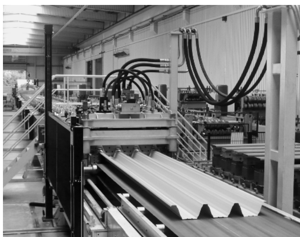
Bild 1-6 Rollformanlage zur Herstellung von Stahltrapezprofilen
