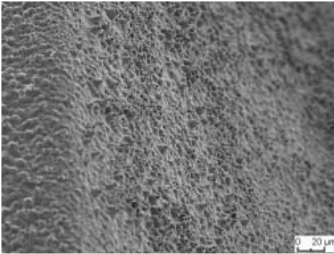
Abb. 1.5 Kegelförmige Porenstruktur durch anodische Oxidation mit glatten Arealen in den Zwischenbereichen (REM-Aufnahme TiUnite; Fa. Nobel Biocare, Göteborg, Schweden).
