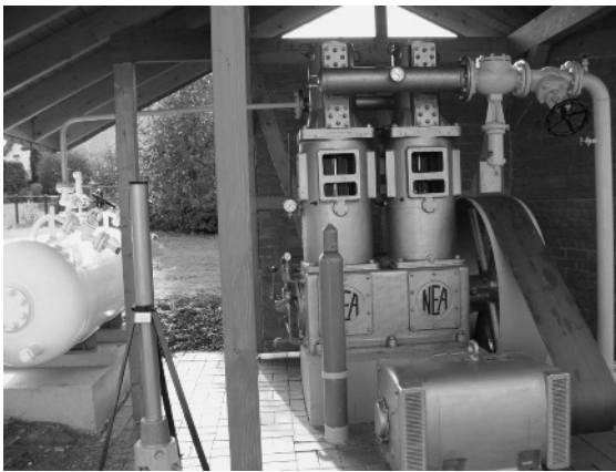
Abb. 1.4 Historische Kohlendioxid-Verflüssigungsanlage in Herste (mit Informationstafel) (Foto: G. Schwedt).
