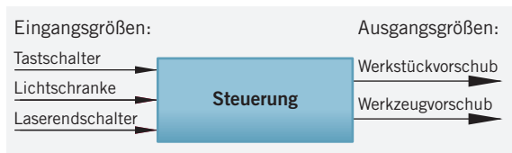
2 Darstellung einer offenen Steuerung
