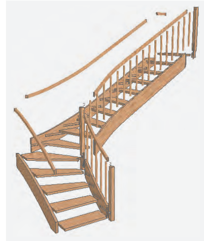
4 Elemente der viertel-gewendelten Pfosten-treppe
