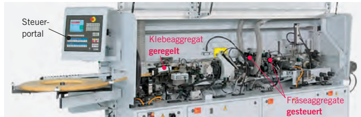
1 Steuerung und Regelung an einer Kantenanleimmaschine ( edge banding machine )
