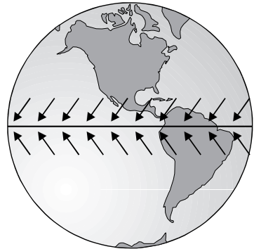
Abb. 1.5–3 Die zum Äquator wehenden Passatwinde werden durch die Corioliskraft der Erdrotation abgelenkt.
