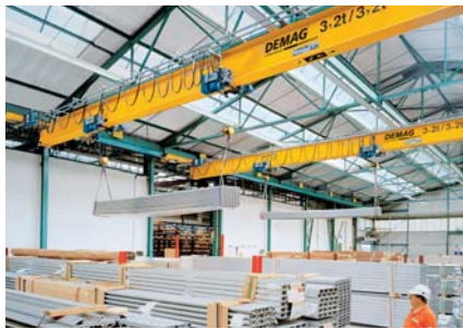
der Elektrokettenzug electric chain hoist مرفاع كهربائي ذو سلسلة بالا بر برقي زنجیری
