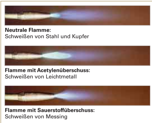
Bild 3: Acetylen-Sauerstoff-Flammen
