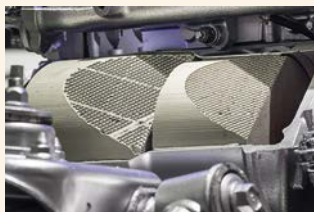
Bild 2: Kfz-Katalysator zur Reduzierung der Abgasemissionen
