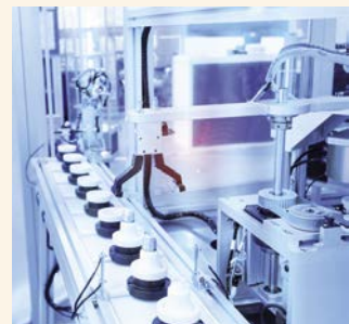
Bild 2: Herstellung von Kompaktleuchtstofflampen
