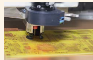
Bild 3: Bohren einer Platine
