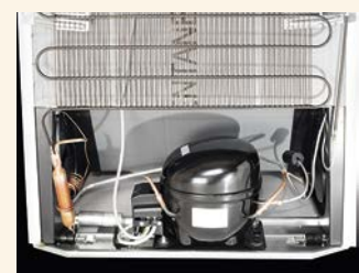
Bild 4: Kompressor als Subsystem des Kühlschranks
