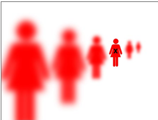
Abbildung 10-4 Schärfentiefeverhalten einer (Semi-)Prof-Kamera mit großem Bildsensor, wenn auf ein entferntes Objekt fokussiert wird: die Schärfentiefebene ist sehr klein und erlaubt eine genaue Hervorhebung durch Schärfe/Unschärfe.
