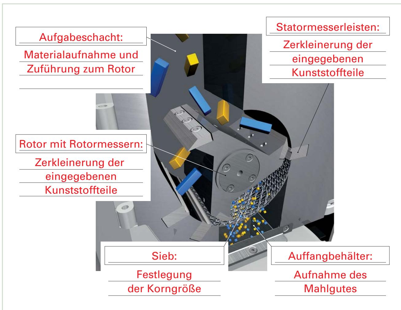
21. Bei der Herstellung von Kunststoffteilen entstehen Abfälle in Form von Angüssen, Butzen, Anfahrteilen usw. Sie können in zerkleinerter Form dem Produktionsprozess wieder zugeführt werden, um Materialkosten zu sparen.
