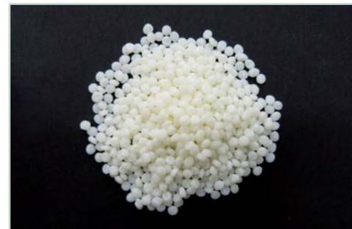
30. Das Granulat wird auf Extrusionsanlagen hergestellt. Dabei wird zwischen Heiß- und Kaltgranulierung unterschieden.
