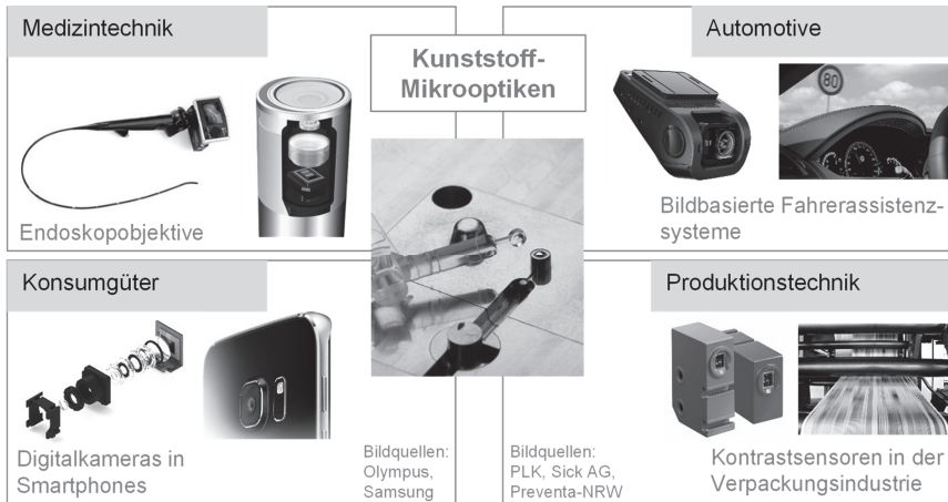
Bild 1.1: Anwendungsbeispiele für Kunststoff-Mikrooptiken
