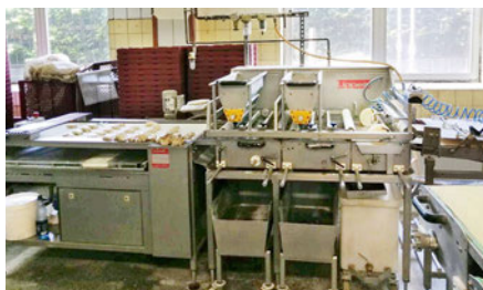
die Brötchenstraße mit Kopfmachine / die Brötchenstraßen mit Kopfmaschinen bun line
