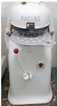
die Brötchenpresse, Schleifmaschine mit Wirkteller / die Brötchenpressen, Schleifmaschinen mit Wirktellern divider rounder with moulding plate
