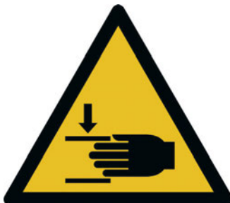
nicht in laufende Maschine greifen Do not reach into running machine
