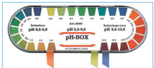
Bild 3: Universal-Indikatorpapier mit drei Papierrollen für verschiedene pH-Wert-Bereiche
