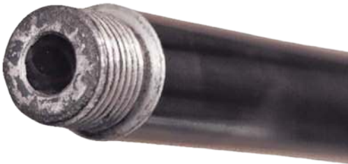
Abb. 12.3: Werden Dämpfer dauerhaft auf der Waffe belassen, kommt es meist auch an der Laufmündung zu Schäden.
