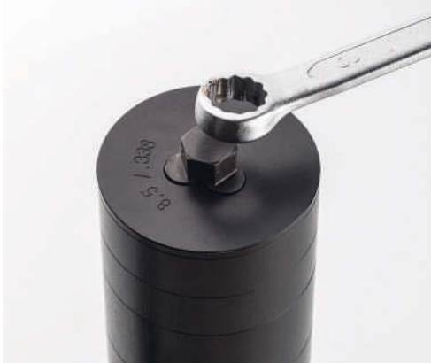
Abb. 12.5: Ein geniales Hilfsmittel zum Zerlegen seiner Dämpfer bietet Roedale Precision an: Das eigens gefertigte Bit greift in die Geometrie der Blenden. Mithilfe einer Ratsche und eines Schraubstocks lassen sich die Module einfach zerlegen.
