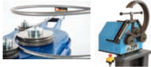
Diese Biegemaschinen gibt es in Horizontal- und Vertikalausführung.
