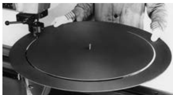
5 Gratfreies Schlitzen eines Blechringes
