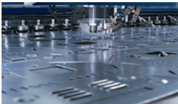
2 Kiemen eines Verkleidungsbleches
