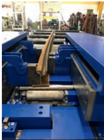
2 Richten einer Schiene
