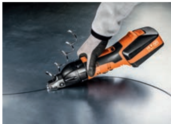
4 Schlitzen einer Innenkontur
