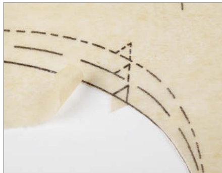
Passzeichen ausschneiden Damit die Nahtlinie stabil bleibt, werden Dreiecke „nach außen“ geschnitten.
