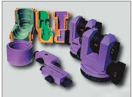
Bild 2: Modelle und Kernkästen aus Holz und Kunststoff
