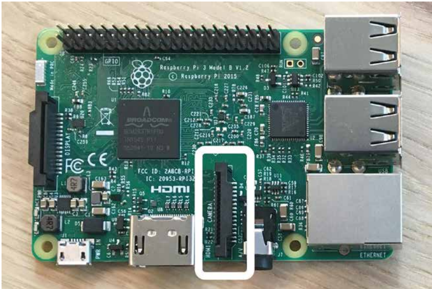
Abb. 9-2 Die serielle Schnittstelle für die Raspberry-Pi-Kamera
