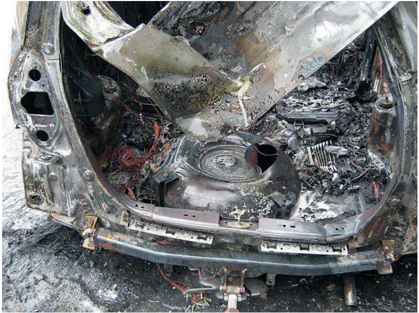
Abb. 16: Aufgerissener LPG-Tank nach Brandeinwirkung. (Quelle: Feuerwehr Warburg)
