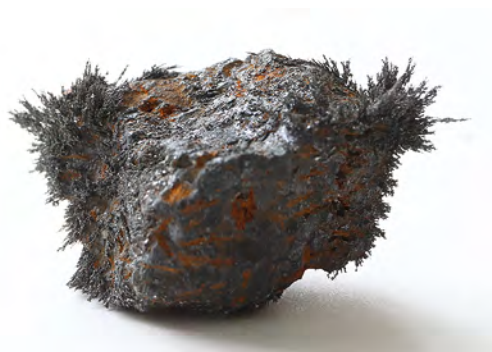
Abb. 2 Magneteisenstein zieht Eisenfeilspäne an.
