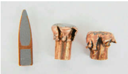
Nosler Partition Zweikammergeschoss mit geborgenen Geschossen
