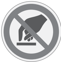
Bild 8.4.5 Hinweisschild gemäß DIN 4844-1 und DIN EN ISO 7010 P010 „Berühren verboten“
