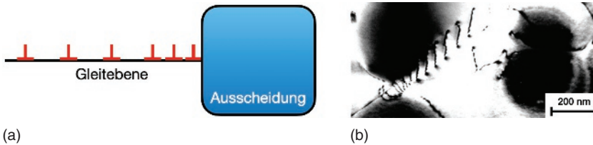
Abb. 1.31 Versetzungsaufbau an (a) einer Ausscheidung schematisch und (b) an einer \text{Ni}_3\text{Al} -Ausscheidung in einer Superlegierung für Turbinenschaufeln (TEM-Aufnahme).
