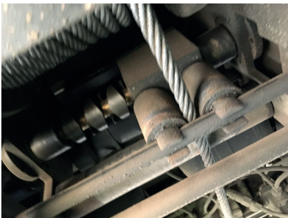
Abbildung 19: Bewegliche Seilführung auf Kreuznutwelle (Quelle: Siekaup)
