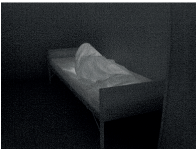
Abb. 131: Vermisste Person unter Bettdecke (Wärmebild). (Quelle: Linde/Dittrich)
