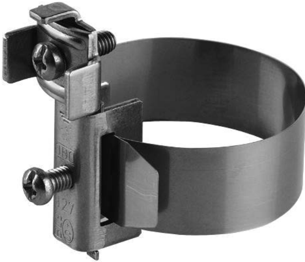
Bild 4.15 VA-Rohrschelle zur Herstellung eines Schutzpotentialausgleichs (Quelle: OBO Bettermann)
