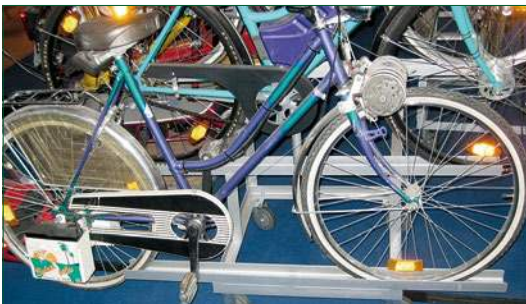
Bild 3: Reibrad antrieb auf das Vorderrad. Akku (Blei-Technologie) in Gepäcktaschenposition.
