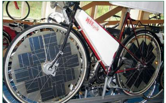
Bild 4: Fahren mit Solarenergie. Der Motor wirkt als Reibrad auf das Vorderrad.
