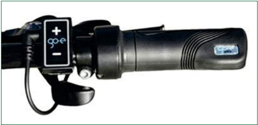
Bild 3: Motorsteuerung durch Drehgriff (ONwheel power grip)
