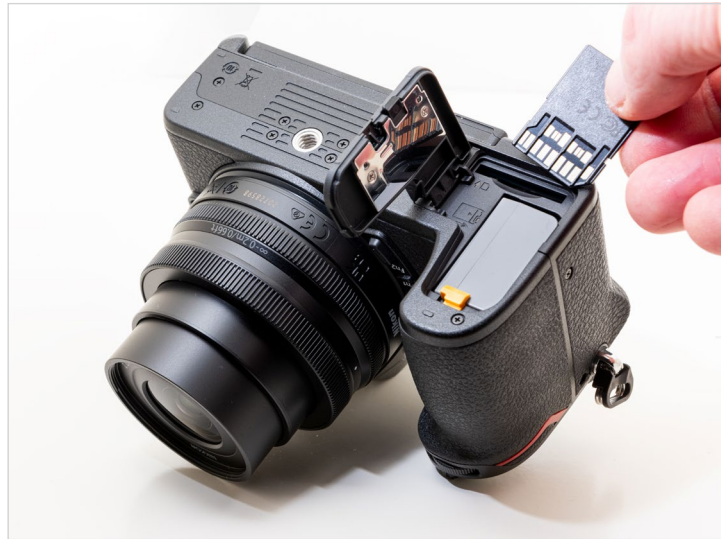
Abb. 2.6 Der SD-Slot liegt unter der Klappe des Akkufachs, oberhalb des Akkus. Schieben Sie die SD-Karte mit der abgeschrägten Kante nach rechts unten bzw. mit den Kontakten nach vorn in das Fach, bis sie einrastet. Zum Herausnehmen drücken Sie die Karte leicht in das Fach, damit sich die Arretierung löst und Sie die Karte herausziehen können.
