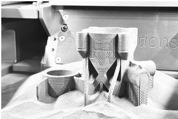
Abbildung 2: Mittels PBF-LB/M gefertigter Lenkungskäfig aus Ti-6Al-4V
