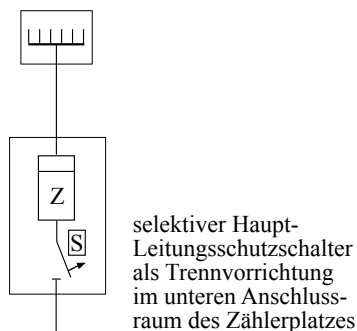
Bild 13.6 Räumliche Anordnung der Trennvorrichtungen (SH-Schalter) zum Freischalten des Stromkreisverteilers
