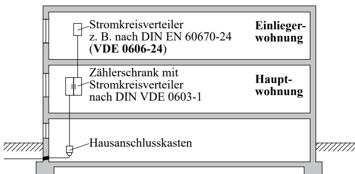
Bild 13.3 Anordnung von Stromkreisverteilern im Einfamilienhaus mit Einliegerwohnung: Stromkreisverteiler für Hauswirt im Zählerschrank integriert nach DIN VDE 0603-1 sowie Stromkreisverteiler nach DIN EN 60670-24 ( VDE 0606-24 ) für Einlieger separat in Einliegerwohnung
