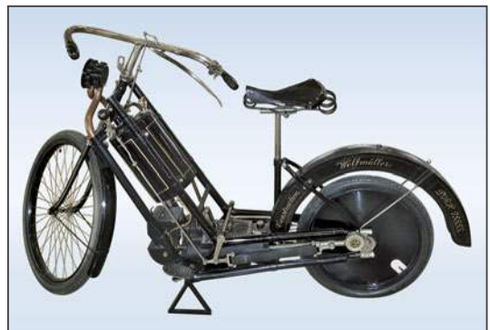
Bild 3: Das Hildebrand- und Wolfmüller-Motorrad mit Glühzündung
