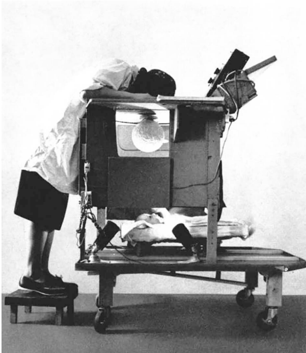
Abb. 1.1: Looking Chamber. Gerät, das bei der Fantz-Präferenzmethode zur Untersuchung der visuellen Fähigkeiten von Säuglingen verwendet wurde. Quelle: Fantz (1961).
